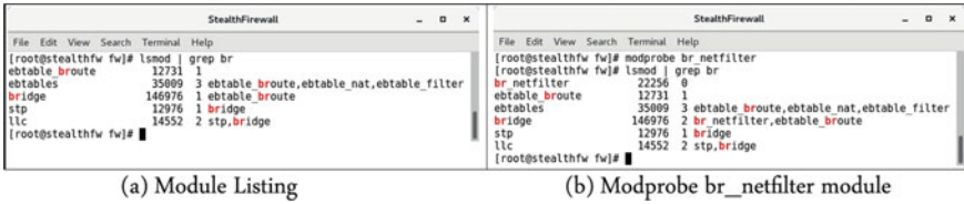
Fig. 3 Enabling br_netfilter module
