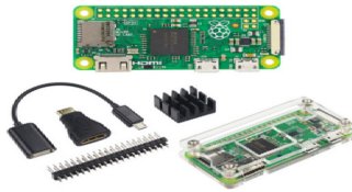
Fig. 4. Raspberry pi zero.
