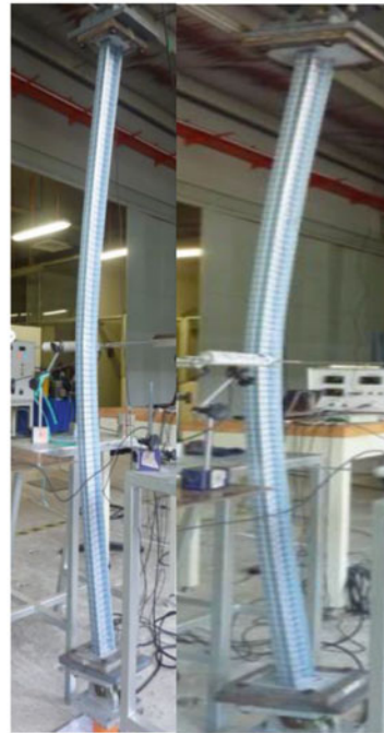
BU75-S950-L2000 BU90-S950-L2000 (d) Slender column
