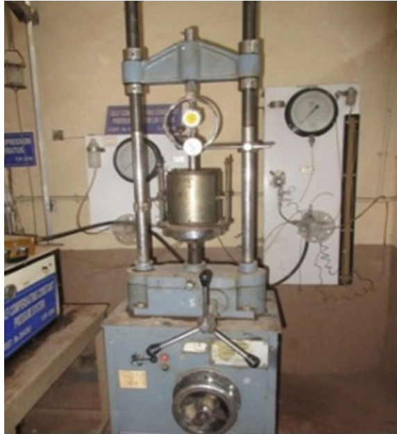
Fig. 2 CBR test apparatus
