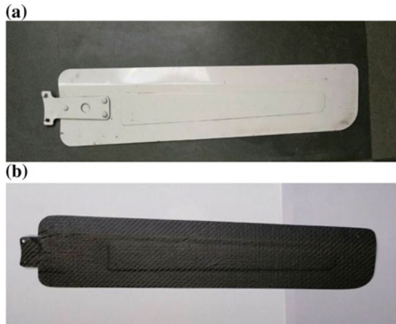
Fig. 1 a Conventional sheet metal fan blade (orient). b CFRC fan blade
