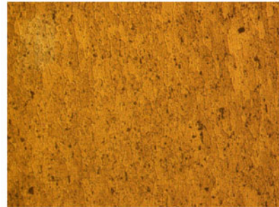
(d) Microstructure of Al 6061 base metal with 200× magnification
