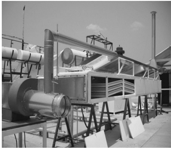
Fig. 5 Direct type solar dryer (Castillo-Téllez et al. 2017)
