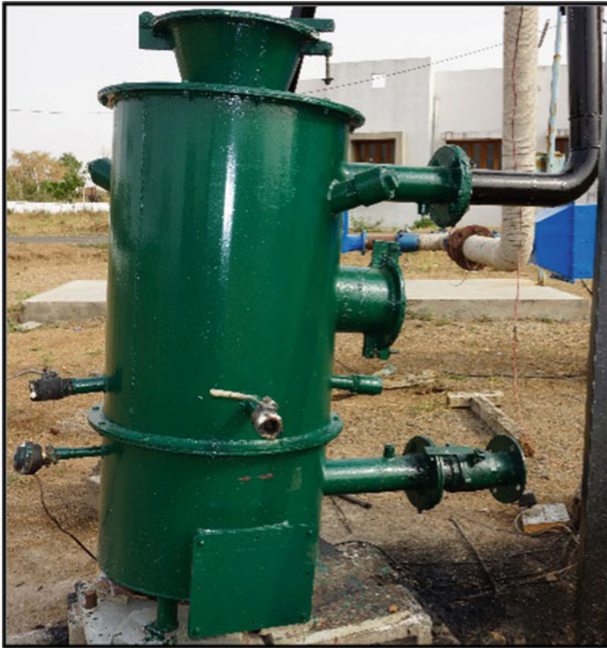
Fig. 1 Actual photographic view of updraft gasifier
