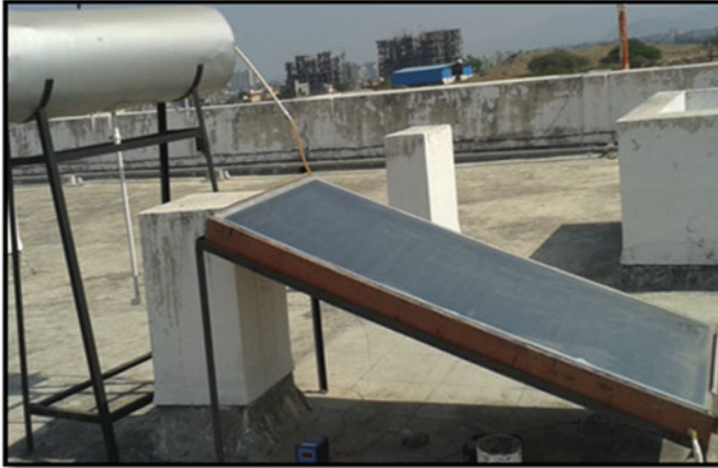
Fig. 3 Actual setup of concrete solar collector
