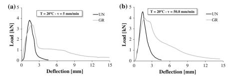
Fig. 6 3PB test results: a 5.0 mm/min; b 50.8 mm/min
