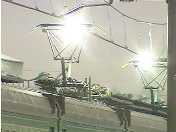
Fig. 4.3 Ice accretion on electric contact wire of a railway line (Source: Ministry of Civil Defence, Emergencies and Disaster Relief of Russian Federation. http://www.mchs.gov.ru/ . Copyright: http://www.mchs.gov.ru/ . Copyright «МЧС России», 2010. Все права на материалы, находящиеся на сайте, охраняются в соответствии с законодательством РФ. При полном или частичном использовании материалов ссылка на mchs.gov.ru обязательна [Copyright “Ministry of Civil Defence, Emergencies and Disaster Relief of Russian Federation”, 2010. The rights to all the materials on this web site are protected in accordance with the Russian legislation. If using the materials, the reference to the mchs.gov.ru is required])
