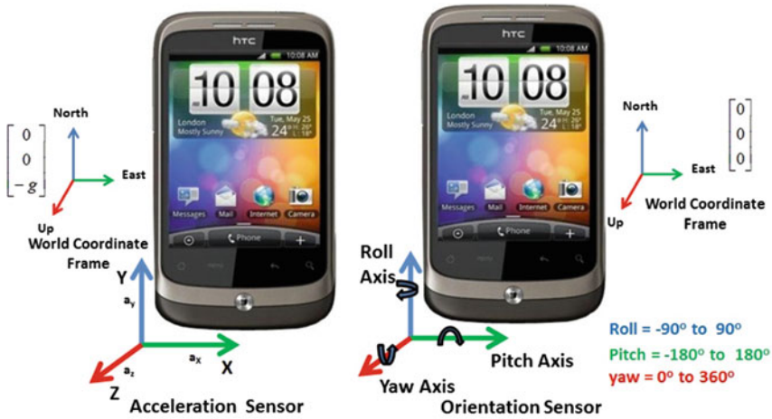
Fig. 14.3 Smart phone’s sensors
