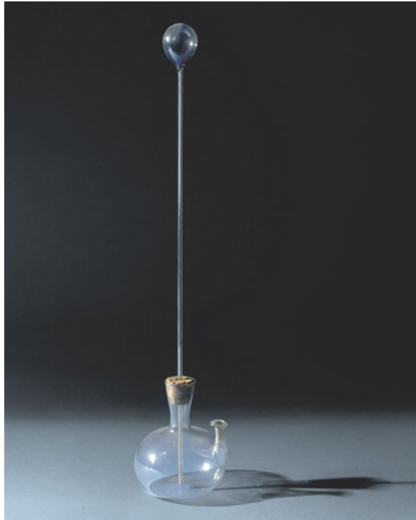
Fig. 5.2 Replica of Galileo's thermoscope (Istituto e Museo di Storia della Scienza, Firenze. Inv. 2444)
