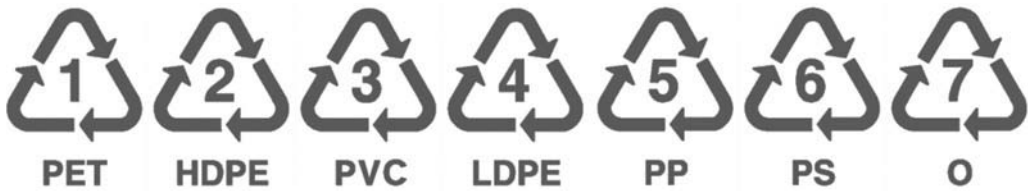
Figura 8.13 Codifica delle materie plastiche per agevolare la raccolta differenziata e il riciclaggio.
