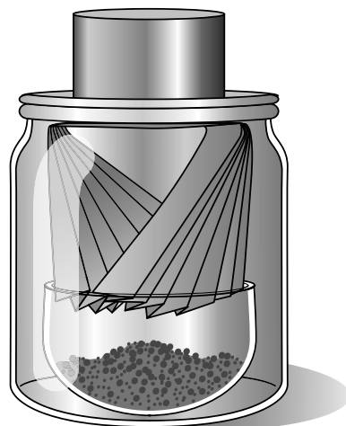
Figura 4.31 Test di Robinson per valutare il potenziale odoroso di un materiale di packaging.
