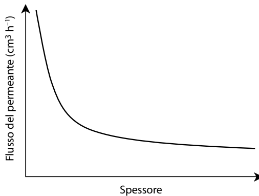
Figura 4.4 Effetto dell'aumento di spessore sulla permeabilità.
