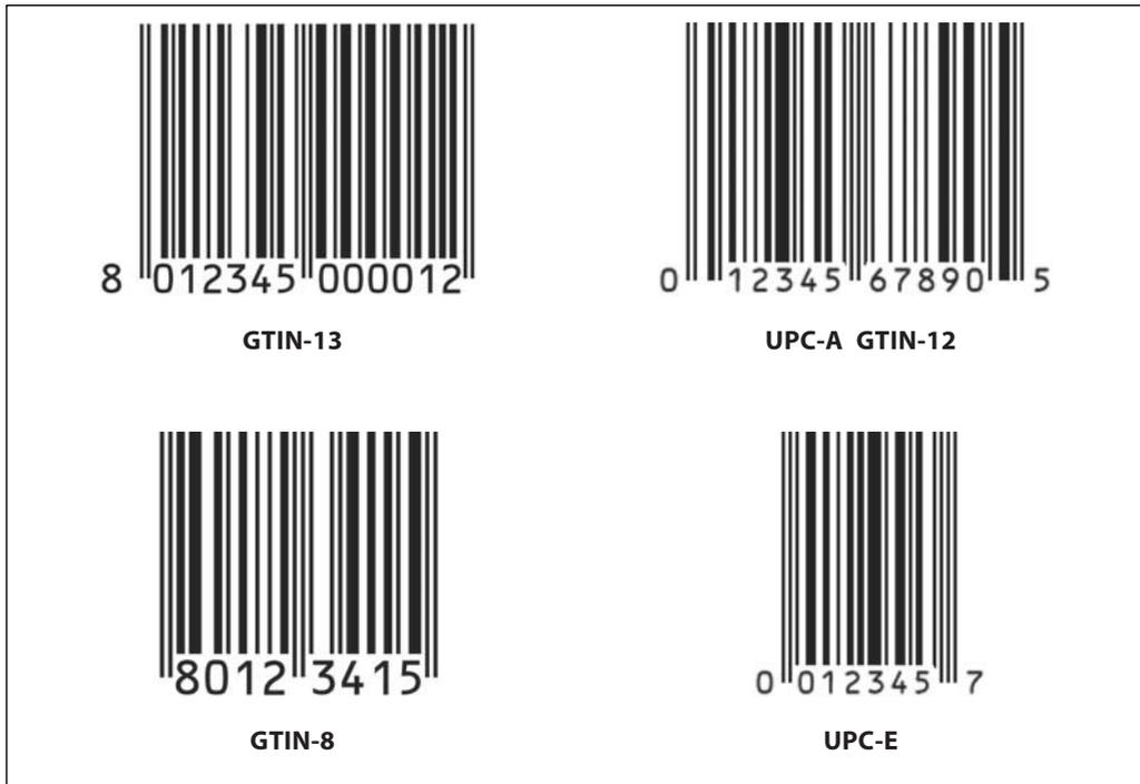
**Figura 14.13** Alcune tipologie di codici a barre.
