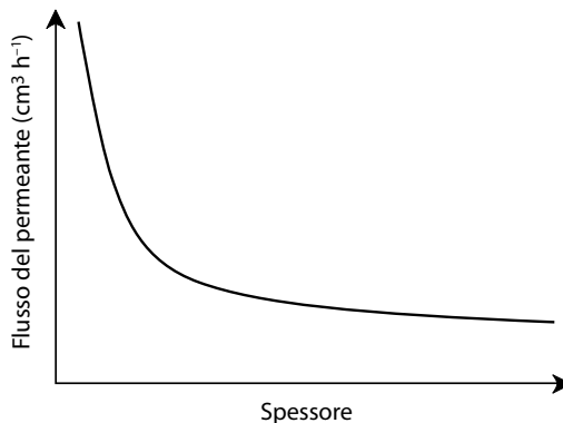
Figura 4.4 Effetto dell'aumento di spessore sulla permeabilità.
