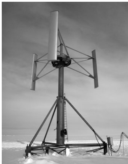
Fig. 4 Generatore ad asse verticale da 20 kW sviluppato dalla Hochschule Bremerhaven per la stazione Neumayer del Dronning Maud Land, in Antartide (Foto: Hannes Grobe)
