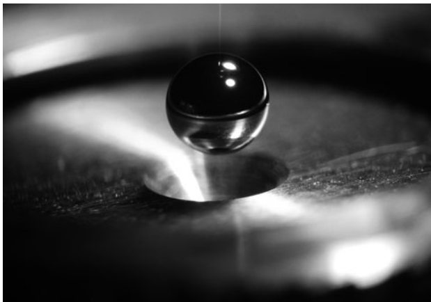
Fig. 5 Un bersaglio dei laser della NIF: un involucro di 2 millimetri di diametro contiene idrogeno allo stato criogenico (Foto: LLNL)
