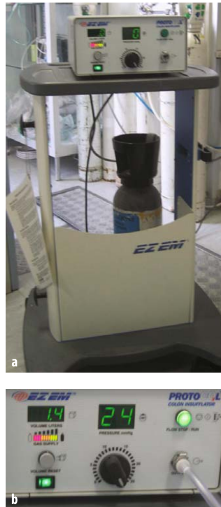
Fig. 4.6. a Pompa automatica di CO 2 . b Sul fronte della pompa automatica di CO 2 sono presenti due display, di cui quello localizzato sulla sinistra rappresenta la quantità in litri di CO 2 erogata, quello sulla destra la pressione d'insufflazione che in genere è mantenuta costante su un valore di circa 25 mmHg
