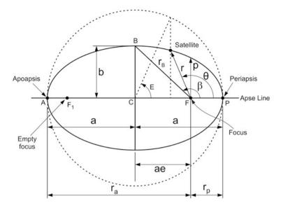
Fig. 3.10 Elliptic orbit parameters
