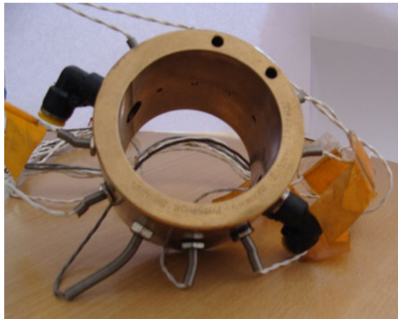
Fig. 4 Actual offset-halves journal test bearing
