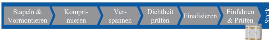
Abb. 16.3 Fertigungsprozess eines Brennstoffzellen-Stacks
