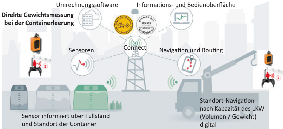
Abb. 3.11 Kombination aus Füllstand, Menge, Gewicht und Routing nach Kapazität, Eichung. (Eigene Darstellung)
