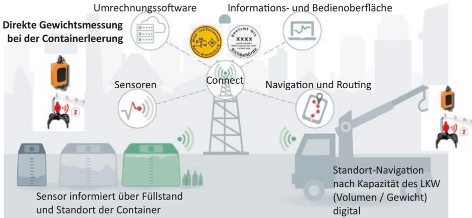
**Abb. 3.11** Kombination aus Füllstand, Menge, Gewicht und Routing nach Kapazität, Eichung. (Eigene Darstellung)
