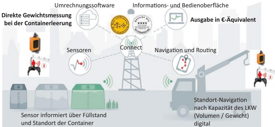
**Abb. 3.12** Kombination aus Füllstand, Menge, Gewicht und Routing nach Kapazität, Eichung und Ausgabe in €-Äquivalent. (Eigene Darstellung)
