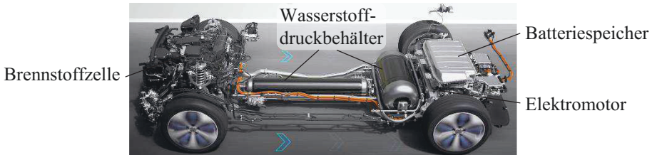
Fig. 3. Anordnung der Wasserstoffdruckbehälter in einem FCEV beispielhaft dargestellt am Mercedes-Benz GLC F-Cell [8].
