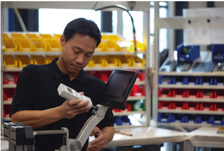
Abb. 7.2 Arbeitsschritt "Kraftmessung" bei Ohnhäuser GmbH
