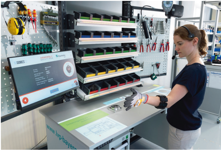
Abb. 7.7 Montagemitarbeiterin bei der Erprobung unterschiedlicher Assistenzsysteme in der manuellen Montage
