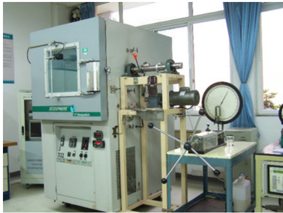
Fig. 3.71 DBR-JEFRI PVT apparatus (Canada)
