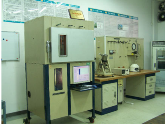
Fig. 3.70 RUSKA-601 PVT apparatus (U.S.)
