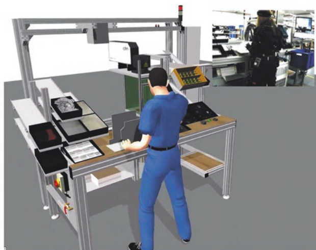
Abb. 4.3 Simulation auf Basis von Motion Capturing
