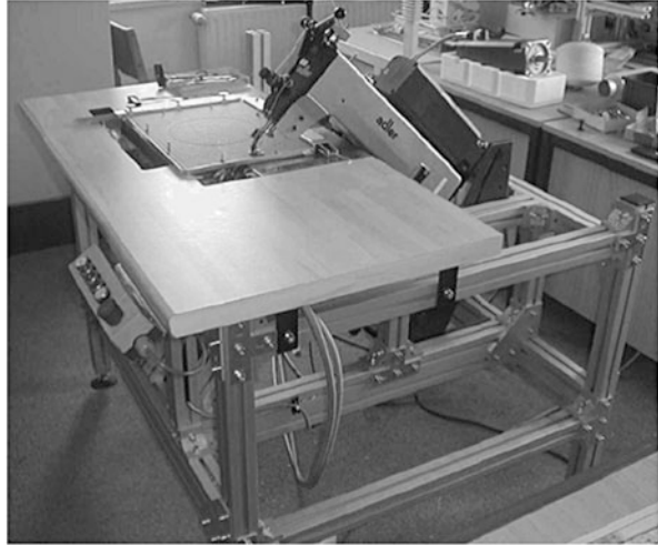
Fig. 12.19 Programmable diagonal sewing machine PSN 3020 (source: Cetex-Institut für Textil- und Verarbeitungsmaschinen gemeinnützige GmbH)
