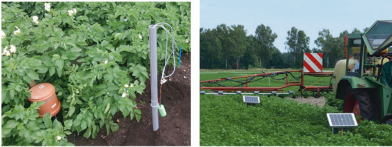
Abb. 1 Sensorik zwischen Kartoffelpflanzen sowie Landmaschine mit Technik zur Übernahme von Messwerten. (Quelle: Eigene Photographien)
