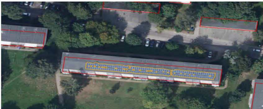
Abbildung 9: Automatisch klassifizierte Solarpanels auf einem Flachdach
