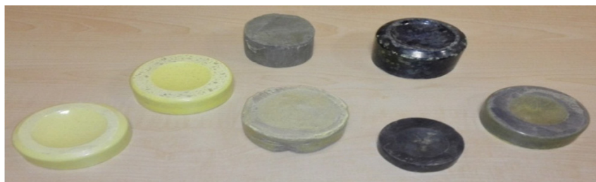
Abbildung 1: Die erhaltenen Kopien von Verbundwerkstoffen basieren auf Schwefelbeton unter Verwendung verschiedener Füllstoffe im Verlauf der Forschungsarbeit.
