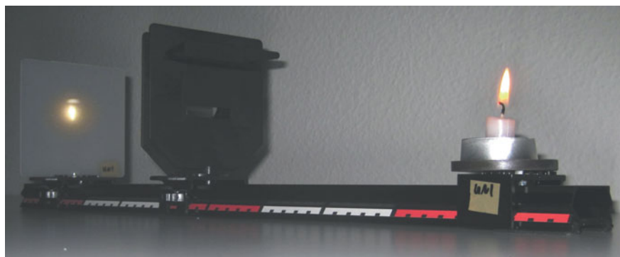
Abbildung 25: Ausgang des Demonstrationsversuchs „Abgedeckte Sammellinse“
