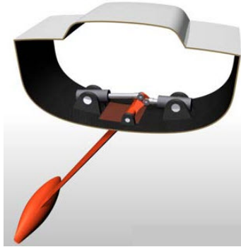
Fig. 3. Canting keel system
