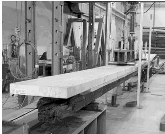
Fig. 8 Four-points bending test setup (EN 408:2010 [15])
