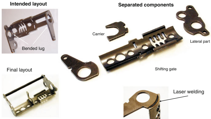
Fig. 5.45 Shifting gate (Source Feintool AG)
