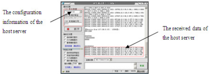
Fig. 17. Server side test result
