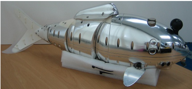
Fig. 2. Actual Implementation of Robotic Fish 'Ichthus V5'
