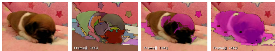
Fig. 1. Video object segmentation: (a) Stabilized frame; (b) Spatiotemporal over-segmentation. (c) Seeds from segment classifier. (d) Spatiotemporal object mask.
