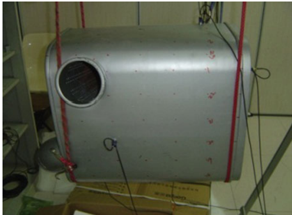
Fig. 7 Muffler modal test site
