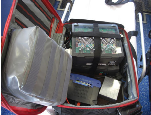
Abb. 1 Die Kommunikationseinheit ist in einen Rucksack integriert und ermöglicht eine sichere und zuverlässige Datenübertragung vom Einsatzort an die Telenotarzt-Zentrale
