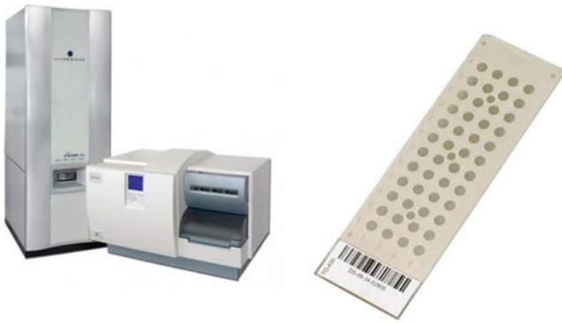
Fig. 5.7 The bioMérieux, Vitek MS with disposable array
