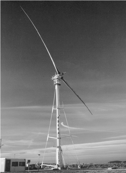
Fig. 2.27. WEC-520 (rotor diameter 52 m, 270 kW), VOITH (Germany), 1982
