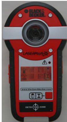
Fig. 1. Black & Decker 'Laserplus' laser-level
