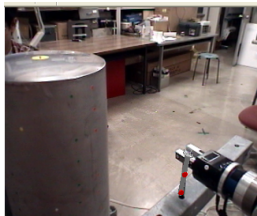
(d) Align the bolt tip to the hole by visual feedback
