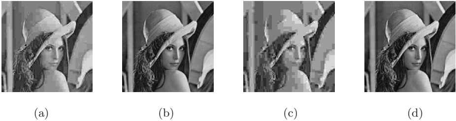
Fig. 1. EZW compression compared to JPEG: For 0.5 bpp: (a) JPEG; (b) EZW. For 0.25 bpp: (c) JPEG; (d) EZW
