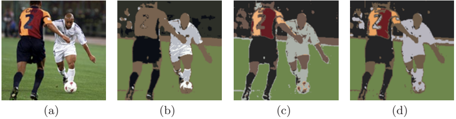
Fig. 3. Segmentation results. (a) original image; (b) EM; (c) VBEM; (d) VBDEM.
