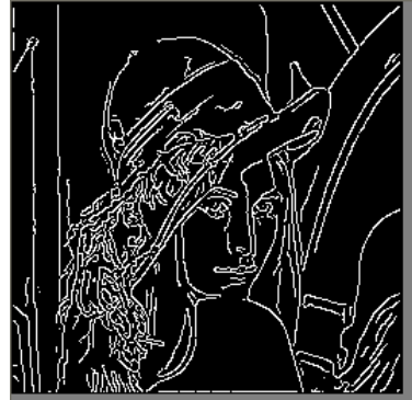
(d) Edge map after parallel bilateral filtering on hex
