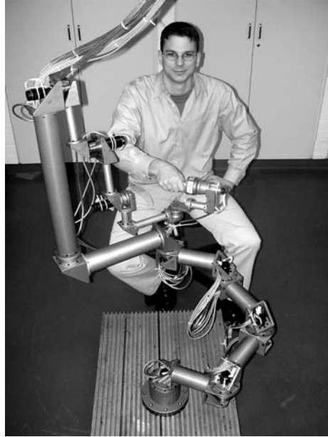
Fig. 2.5. Haptic display ViSHARD10
