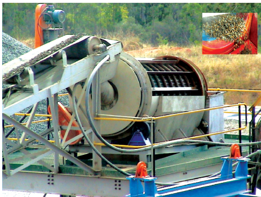
Fig. 5.8. Trommel for concentrate separation
