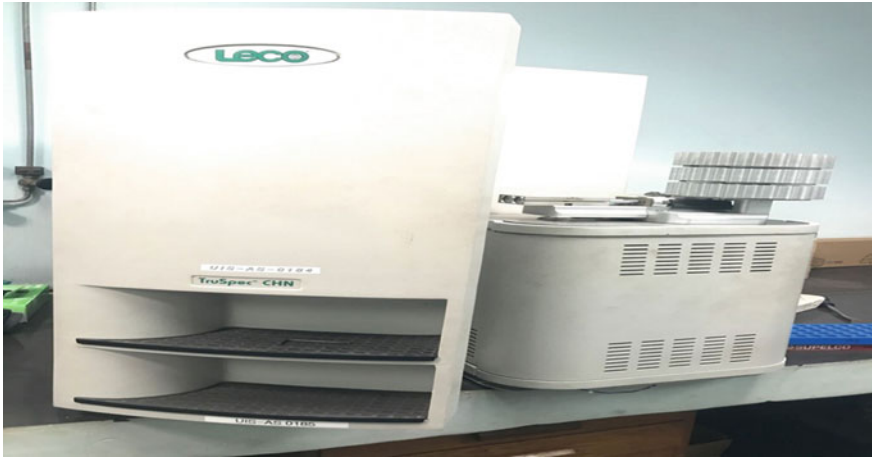
Fig. 3 LECO TruSpec CHN analyzer
